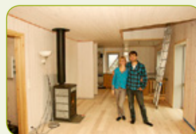
Huset har en effektiv vedovn som sammen med solfangere på taket varmer opp en vann-tank for vannbåren varme i gulvet.
